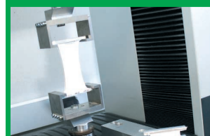
Test réussi : mastic allongé à 800% sans se décoller, ni se déchirer.
