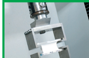
Dans un dynamomètre, le mastic est étiré.
