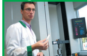
Olivier Huss va contrôler la résistance à l'étiement d'un mastic.
